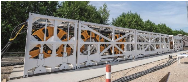
(1) Das BAUER Cube System wurde exakt in Container-Abmessungen entwickelt.
